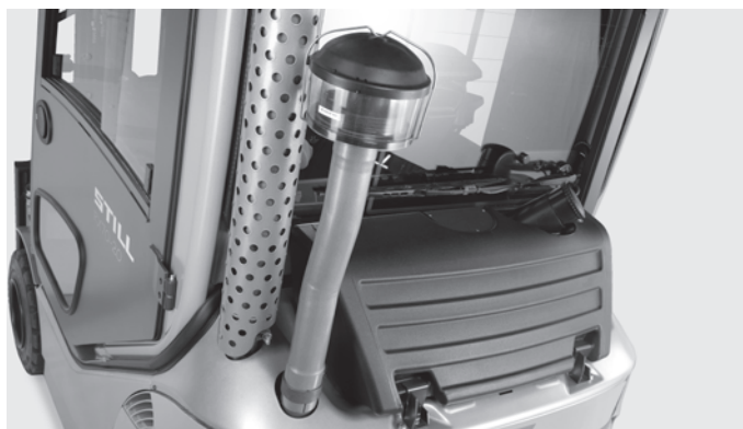
Filtro de aire tipo ciclón para una toma de aire del motor limpia
