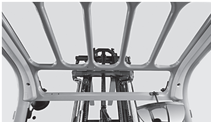
Óptima visibilidad gracias a los perfiles estrechos del tejadillo protector
